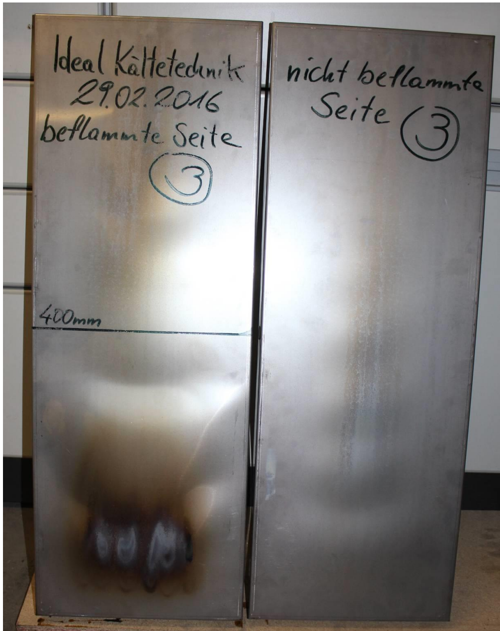
Bild 1: Ergebnis der Schlyter-Prüfung der Edelstahl-Kühlelemente am Beispiel des Tests Nr. 3 aus 3
